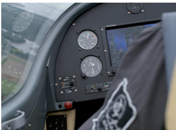
Bij 27 inch manifold pressure en 5.070 rpm: 235 km/h. (Foto's: Ruud Vos)
