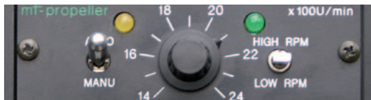
MT propeller is zowel handmatig als automatisch te verstellen. (Foto's: Ruud Vos)
