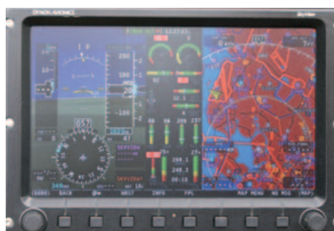
Driedelig panel: links vluchtgegevens, midden systeem-informatie, rechts GPS/moving map.
