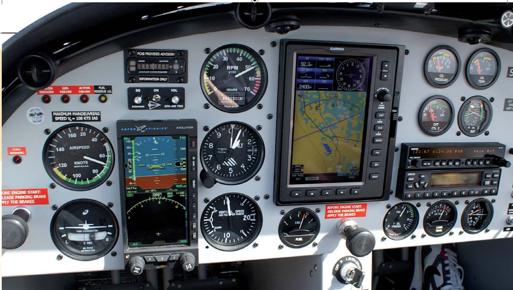
In het panel is een Aspen EFD1000 PFD (links) aangebracht en een Garmin G695 MFD met rechts daarvan Garmin's SL30 tranceiver (boven) en een GTX328 transponder (onder). Een Zaon PCAS MRX (links boven de motortoerentalmeter) geeft eventuele traffic alerts af. Tevens is een Kannad 406 AF-Compact ELT aanwezig waarvan de unit zich onder de linker stoel bevindt. De overdaad aan meters en getallen stoort daarbij tijdens het vliegen op geen enkele wijze.
